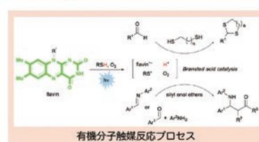
有機分子触媒反応プロセス
